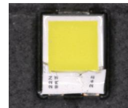
図2. シリコン樹脂の損傷例
