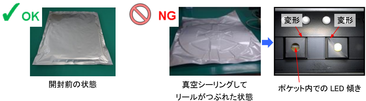
図 1. 真空保管とエンボスキャリアテープの変形
