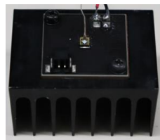
写真 6 フィン下向き (空気の流れを妨げた向き)
