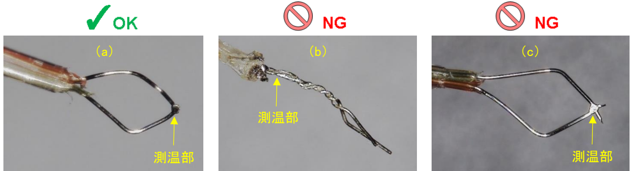
図 3. 熱電対の測温位置
