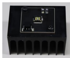
写真5 フィン下向き (空気の流れを妨げた向き)
