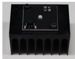
写真5 フィン下向き (空気の流れを妨げた向き)
