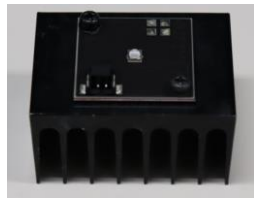
照片 5 让鳍片向下设置 (妨碍空气流动的朝向)
