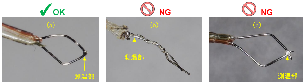
図 4. 熱電対の測温位置
