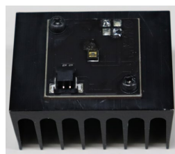
写真5 フィン下向き (空気の流れを妨げた向き)
