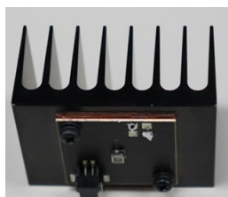
写真4 フィン垂直 (弊社設置向き)
