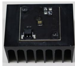
照片 5 让鳍片向下设置 (妨碍空气流动的朝向)
