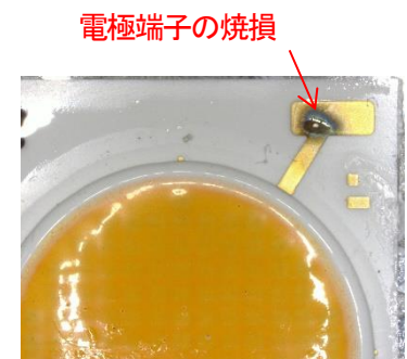
図 14. COB の電極端子焼損例
