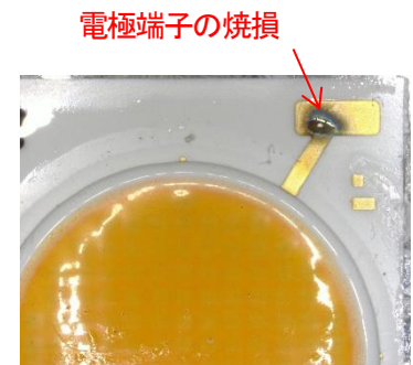
図 14. COB の電極端子焼損例
