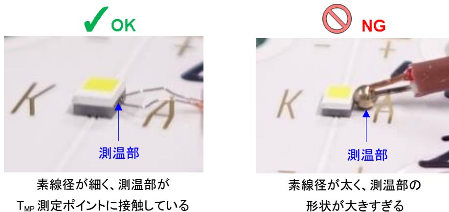
図 2. 熱電対取り付けの例(接着剤塗布前)
