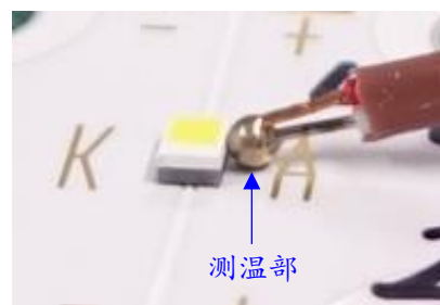
热电偶丝径大、测温部形状过大
