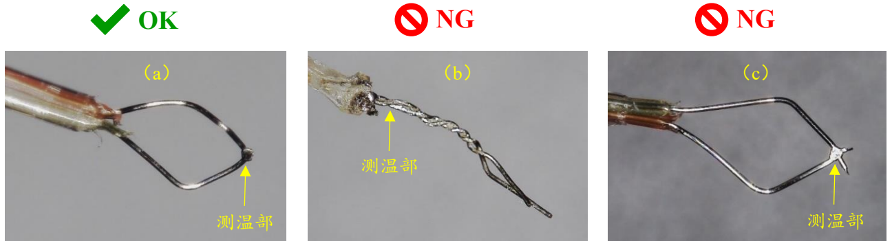
图 3 热电偶的测温位置
