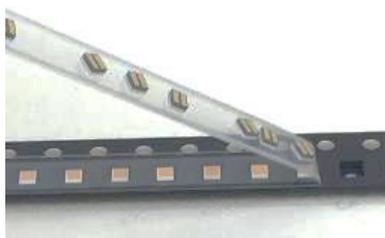
图 18. 静电导致的 LED 粘连
