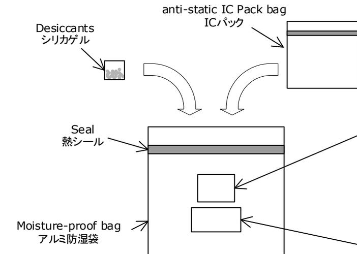
Moisture-proof bags are packed in cardboard boxes with shock absorbing materials to fill empty spaces. アルミ防湿袋を並べて入れ、間隔にはクッション材を詰めます。
