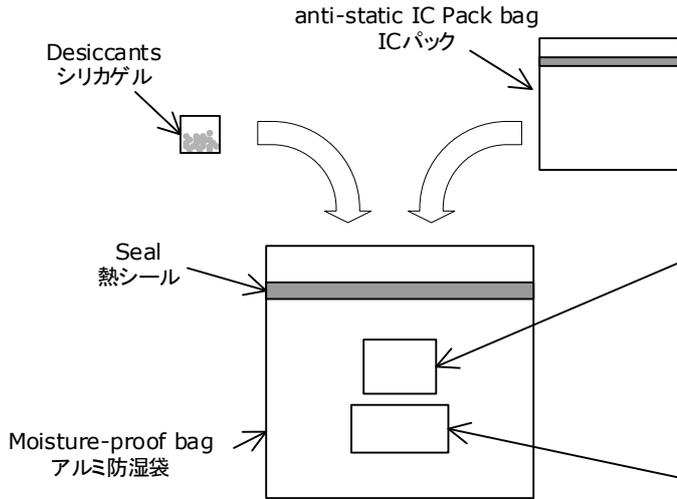
Moisture-proof bags are packed in cardboard boxes with shock absorbing materials to fill empty spaces. アルミ防湿袋を並べて入れ、間隔にはクッション材を詰めます。
